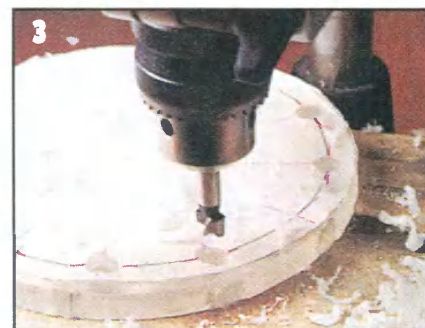
Глухие отверстия под хромированные трубки сверлят сверлом Ø10 мм при небольших оборотах дрели, закрепленной в стойке.
