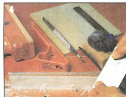
Шлифуют кромки деталей в несколько этапов, последовательно применяя наждачную бумагу все более мелкой зернистости.
