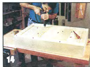
Уложите заднюю стенку в фальцы корпуса и закрепите ее шурупами.
