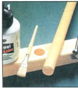
Отверстия в вертикальных стойках под перекладины высверливают сверлом Форстнера ∅25 мм. перекладины вставляют в отверстия, обильно смазывая столярным клеем.
