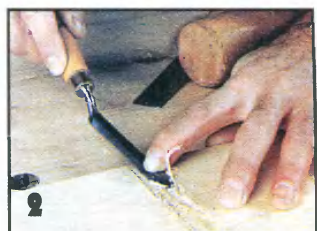
Выборка стамеской поперечного паза глубиной 3 мм на внутренней поверхности дна.
