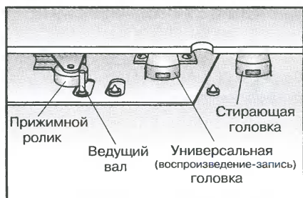
Рис. 4. Основные детали звукопроизводящего тракта плеера, требующие регулярной чистки.
