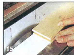
Сделайте на деталях дверцы фальцы под стекло и подрежьте концы буртиков под углом 45°.
