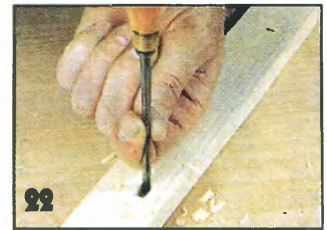
Для обеспечения прочности вырежьте паз в боковине дверцы, соответствующий шипу на ручке.
